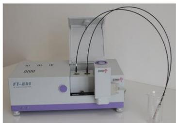
фото 1. ФТ-801 с зондом Art photonics и приставкой МСТ в кюветном отсеке
