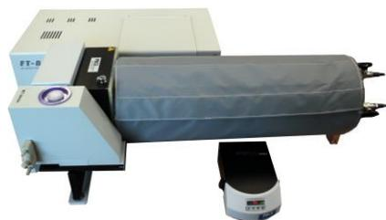
фото 2. ФТ-801 с многопроходной нагреваемой газовой кюветой фирмы PIKE (20м, 200°С)
