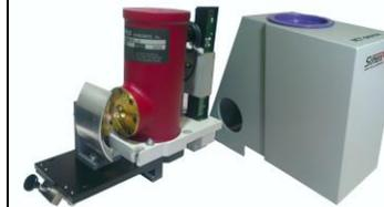
фото 8. Приставка МСТ с детектором (ртуть-кадмий-теллур), охлаждаемым жидким азотом
