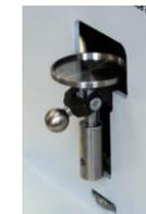
фото 4. ПРИЗ – приставка с видеокамерой, для получения спектров отражения твердых веществ (в т.ч. сыпучих) и спектров двойного прохождения микрообъектов, раскатанных по зеркальной подложке. Вверху - изображение объекта на мониторе компьютера.
